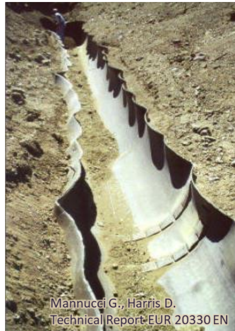
Efekt testu rozwoju pęknięć gazociągu
